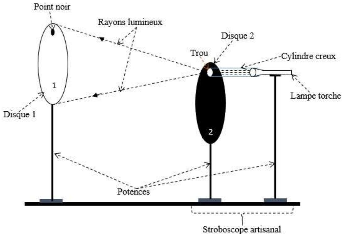
*Figure 1 : Dispositif expérimental*
