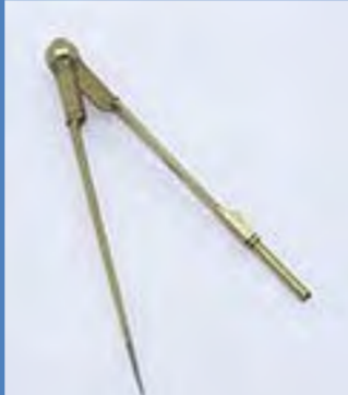
Traceur de parabole de B.Cavalleri
